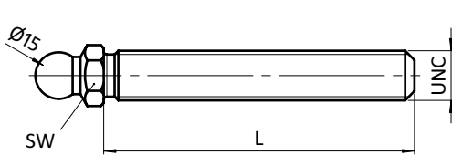
UNC-Gewindestange für Gelenkstellfüße, Kugel 15 UNC Threaded Rod for Swivel Feet, Ball Joint 15
